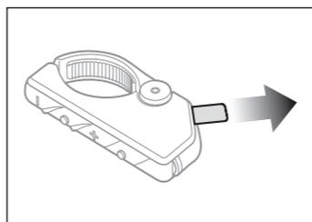
Enlevez la bande en plastique qui protège l'emplacement pour batterie afin de commencer à utiliser la commande à distance.
