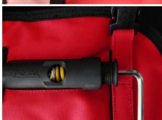
A. Position du percuteur après l'activation: la bille est sortie de son logement, le piston a glissé vers la cartouche et le ressort est visible.
