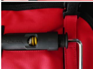
A. Das Foto zeigt den Zustand des Auslösemechanismus nach erfolgreicher Aktivierung: Der Auslösegurt hat die Metallkugel einschließlich der unverlierbaren Sicherungshülse aus ihrem Sitz gelöst. Die Feder hat den Kolben in Richtung Kartusche geschoben und ist durch den Kugelsitz sichtbar.
