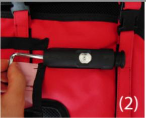
D. Umístěte pístek s úderníkem prstem nebo pomocí imbusového klíče zpět na své místo. To si můžete zkontrolovat otvorem kde je vsazena vytrhávací pojistka s kuličkou.
