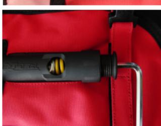
C. Abra la tapa del cojinete con la llave hexagonal de 5 mm que se suministra con la chaqueta. Usted puede usar los dedos en algún momento. No desenroscar la tapa completamente. Con 12 mm fuera del cilindro será suficiente.
