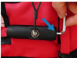
G. Draai de dop verder aan met de 5 mm inbussleutel. Draai vast tot de dop de cilinder van het activerings-systeem raakt.
