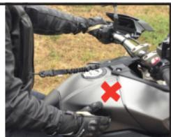
Kontrollera att den fäspunkt som valts är tillräckligt stabil, bör tåla minst 150kg.
