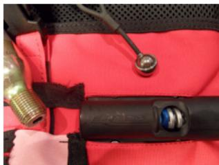
B. Avtryckarens placering efter att ha löst ut: kulan är inte i sin infattningshål, kolven har glidit i riktning mot patronen och fjädern syns.
