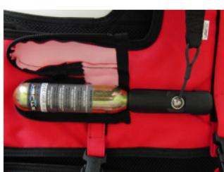
H. Anschließend setzen Sie eine neue CO2-Kartusche ein. Sie muss vollständig hineingeschraubt werden bis das Gewinde vollständig verdeckt ist und der Kapselhals am Auslösegehäuse anliegt. Ziehen Sie die Kartusche nur von Hand an, benutzen Sie kein Werkzeug.
