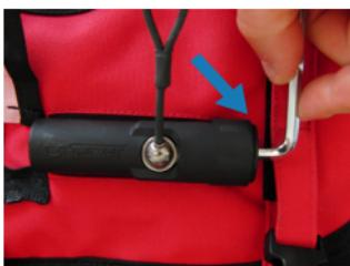
G. Avsluta med att dra åt locket med insexnyckeln. Skruva tills det tar stopp och man inte ser gängorna längre.
