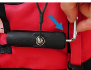
H. A continuación, coloque el nuevo cartucho CO<sub>2</sub>, asegurándose que está completamente enroscado y que no se aprecia ninguna parte de la rosca. No lo enrosque en exceso. El cartucho debe estar en contacto con el plástico del percutor. Si no está perfectamente ajustado, el cartucho no se perforará completamente y no se producirá el inflado del airbag, o este se inflará levemente.
