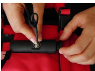
F. Führen Sie die am Auslösegurt befestigte Sicherungshülse einschließlich der Metallkugel in ihren Sitz ein. Drücken Sie sie fest auf Anschlag und halten Sie sie in dieser Position, während Sie die Spannschraube wieder anziehen.
