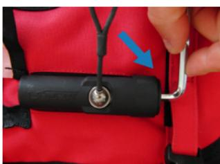
G. Schrauben Sie die Kappe weiter fest, bis sie den Zylinder des Auslösers berührt. Schrauben Sie nicht über diesen Punkt hinaus, da ein zu festes Anziehen den Auslöser beschädigen könnte.
