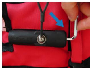
G. Terminez le serrage du bouchon avec la clé Allen de 5 mm. Serrez jusqu'à ce que le capuchon soit en contact avec le cylindre du percuteur. Ne serrer pas trop fort au risque d'endommager le percuteur.
