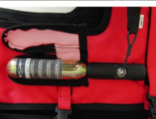
H. A questo punto sostituire con la nuova cartuccia di CO<sub>2</sub>, assicurandosi che sia avvitata completamente fino in fondo. Non stringere in modo eccessivo. La cartuccia dovrebbe essere praticamente a contatto con la plastica del meccanismo. Qualora non fosse stretta a sufficienza, la cartuccia non verrebbe completamente perforata e causerebbe una ridotta o mancata azione di gonfiamento.
