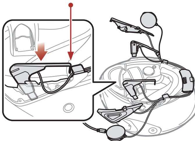
5. Faites glisser le **module de boutons (D)** à la place correspondante. Assurez-vous que les rainures sous le module de boutons coïncident avec les rainures correspondantes.
