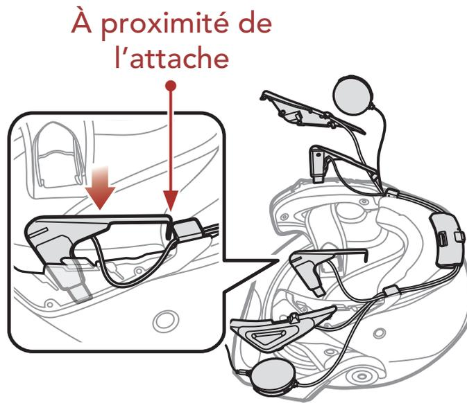
5. Faites glisser le **module de boutons (D)** à la place correspondante. Assurez-vous que les rainures sous le module de boutons coïncident avec les rainures correspondantes.
