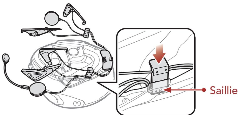
4. Insérez l'extrémité courte de l'antenne à côté de l'attache insérée et faites-la glisser entre les coques interne et externe.
