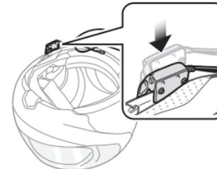
3. Serrez les deux vis jusqu'à ce que la pince de fixation soit fermement fixée au casque moto.
