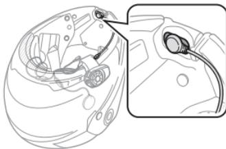
3. Alignez les flèches sur la pince de fixation et les câbles du microphone, et insérez les câbles du microphone dans le connecteur du microphone.
