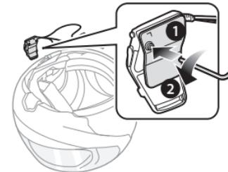
2. Insérez la plaque arrière de la pince de fixation entre le rembourrage interne et la coque extérieure sur la partie gauche du casque moto.
