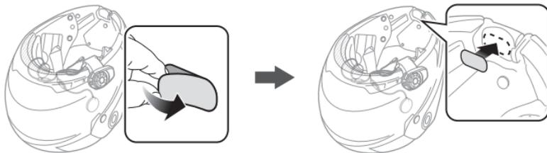
2. Fixez le microphone câblé à la fermeture scratch prévue à cet effet.
