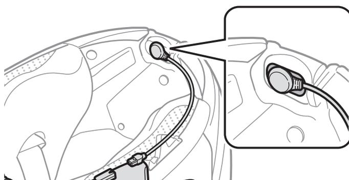
3. Alignez les flèches sur les câbles du microphone et du haut-parleur, et insérez le câble du microphone dans le connecteur du microphone.
