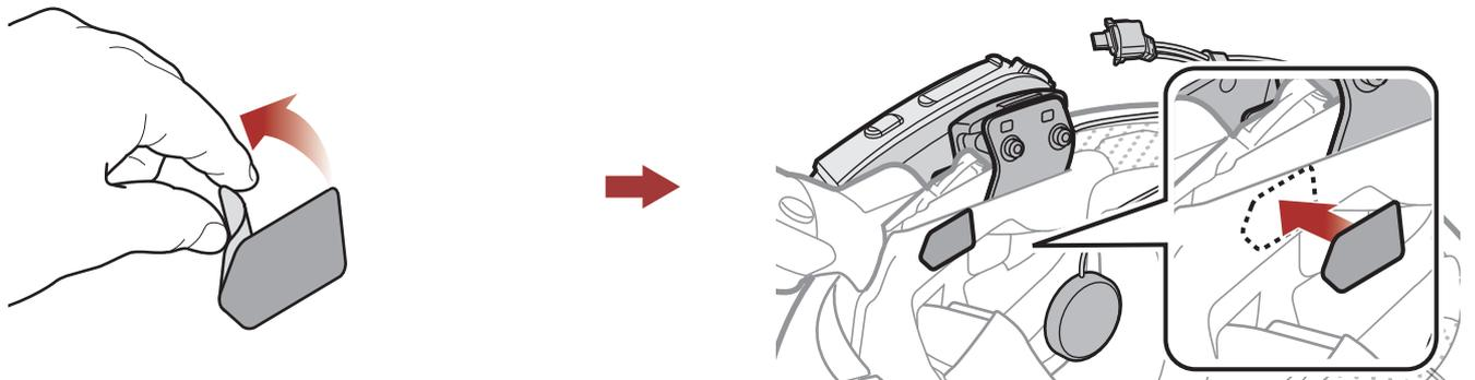
2. Fixez la plaque de montage du microphone perché filaire à la fermeture scratch.
