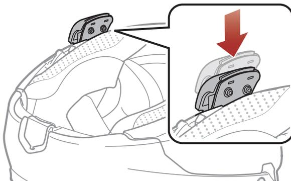
3. Serrez les deux vis jusqu'à ce que la pince de fixation soit fermement fixée au casque moto.
