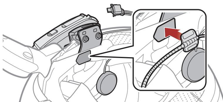
**Remarque :** vous pouvez utiliser le support de microphone sur tige après avoir fixé dessus la fermeture scratch qui permet de le maintenir solidement.
