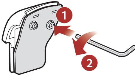
2. Insérez la plaque arrière de la pince de fixation entre le rembourrage interne et la coque extérieure sur la partie gauche du casque moto.
