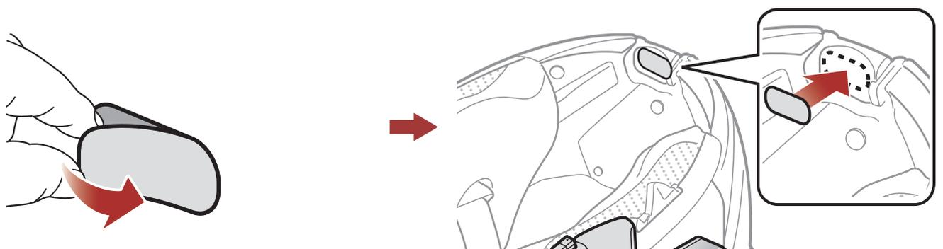
2. Fixez le microphone câblé à la fermeture scratch prévue à cet effet.
