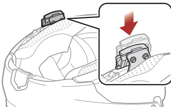
3. Serrez les deux vis jusqu'à ce que la pince de fixation soit fermement fixée au casque moto.
